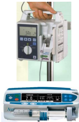
Bomba de perfusión intravenosa instaura una fluidoterapia a un ritmo determinado
